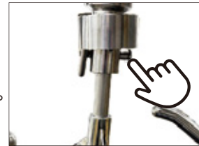
◎1本のピンで取り付けられた攪拌羽根は取り外しが簡単。
