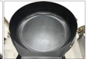
◎攪拌羽根のない内鍋は何も無く、洗浄作業もシンプル。
