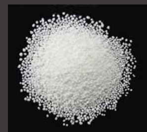
高速混練造粒 薬物含量30%
